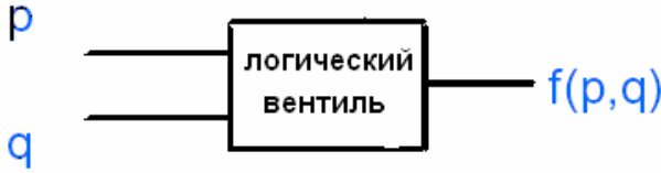
Рис. 2.15. Условная схема логического вентиля с двумя входами и одним выходом
