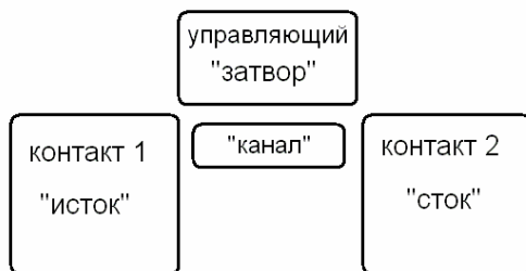
Рис. 1.1. Принципиальная схема транзисторной структуры с управляющим затвором
